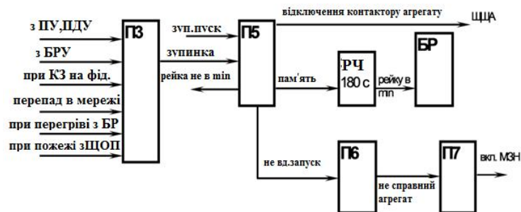
Рисунок 1 – Функціональна схема алгоритму зупинки агрегату
