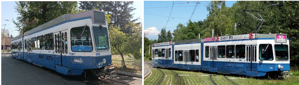
Рисунок 3 – Трамвайний вагон Трам-2000 до модернізації та трамвайний вагон Трам-2000 М після пониження рівня підлоги в середній частині вагона за рахунок додаткової секції
