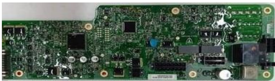
Рисунок 1 – Плата (BMS) керування основної батареї REV03 Tesla model S
