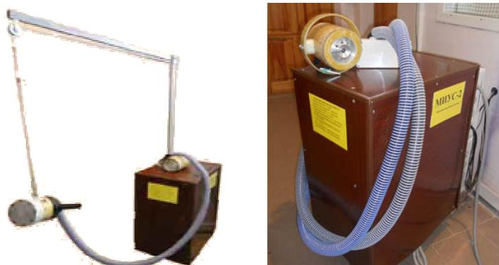
Рисунок 1 – Внешний вид комплекса для магнитно-импульсной рихтовки кузовов автомобилей
