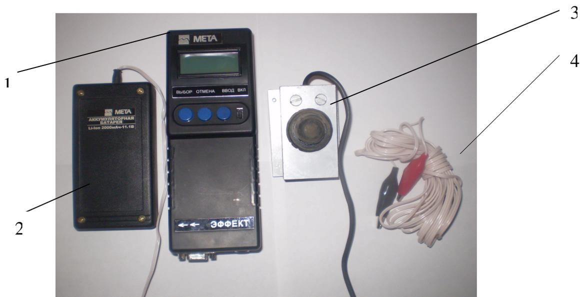
Рисунок 1 - Прибор «Эффект» для проверки тормозной эффективности автомобиля
