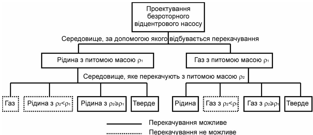
Рисунок 2 – Аналіз можливості роботи нагнітача при перекачуванні різних середовищ
