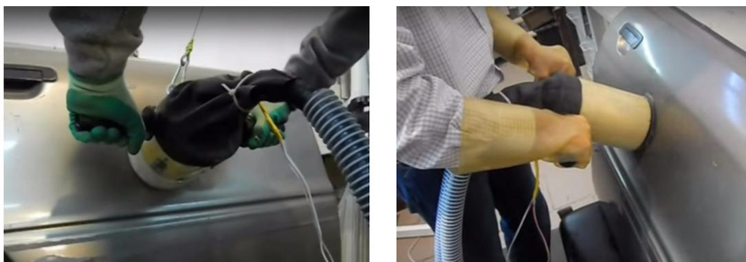
Рисунок 2 –Процесс рихтовки
