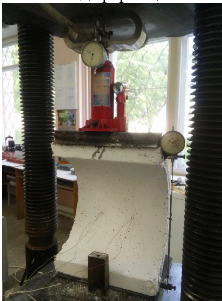
Рисунок 1 – Загальний вигляд дослідження водовідвідного лотка
