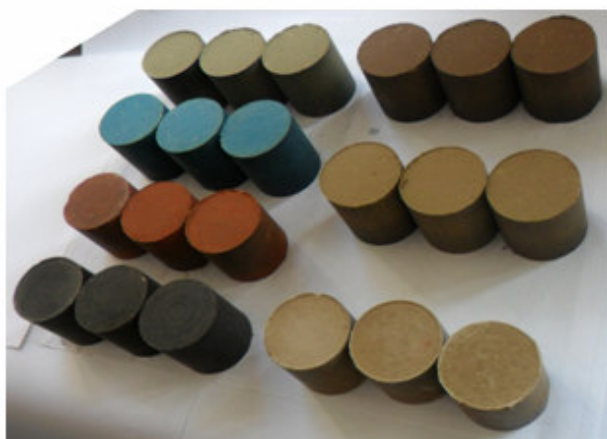
Рисунок 1 – Фото заформованих зразків-циліндрів 50х50 мм
