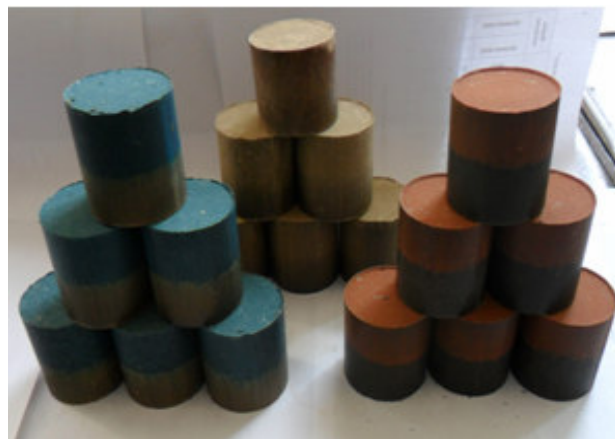
Рисунок 1 – Фото заформованих зразків-циліндрів 50х50 мм
