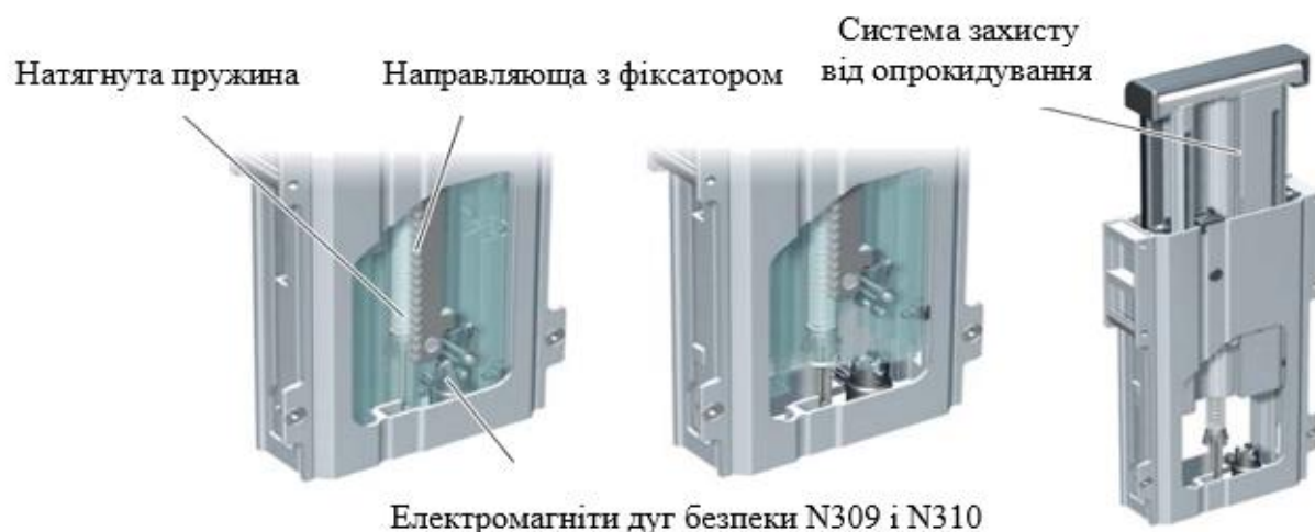
Рис. 3. Механізм спрацювання системи при перекиданні
