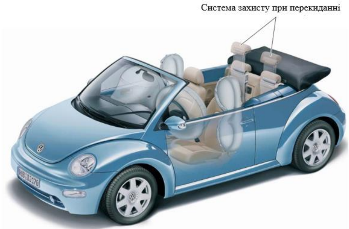
Рис. 2. Система захисту, яка спрацювала, при перекиданні
