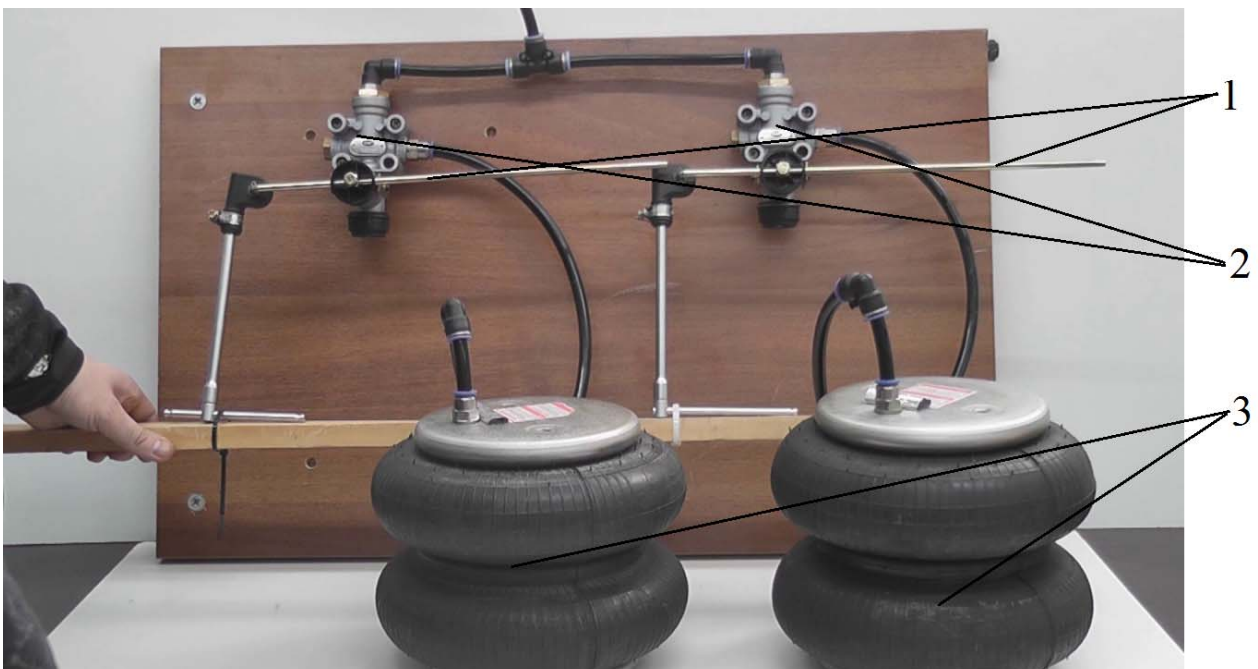
Рис. 2 Система поддрессоривания автобусов с механическими РУП
