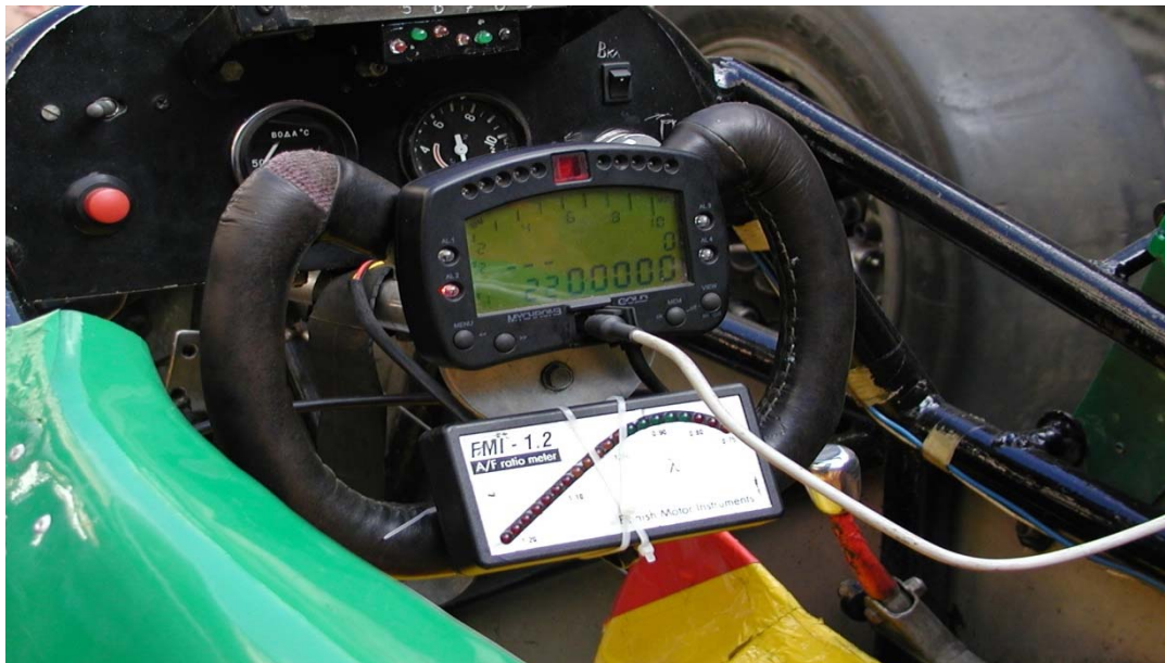
Рисунок 1.1-Розміщення на автомобілі "Естонія -25-ХАДІ" "програмно-апаратного комплексу" AIM My –Chron 3 Gold +Data Logger EVO3 kart systems"
