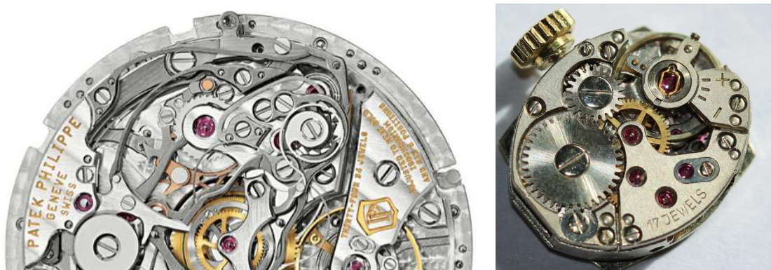
Рисунок 3 – Механизмы с ручной заводкой
