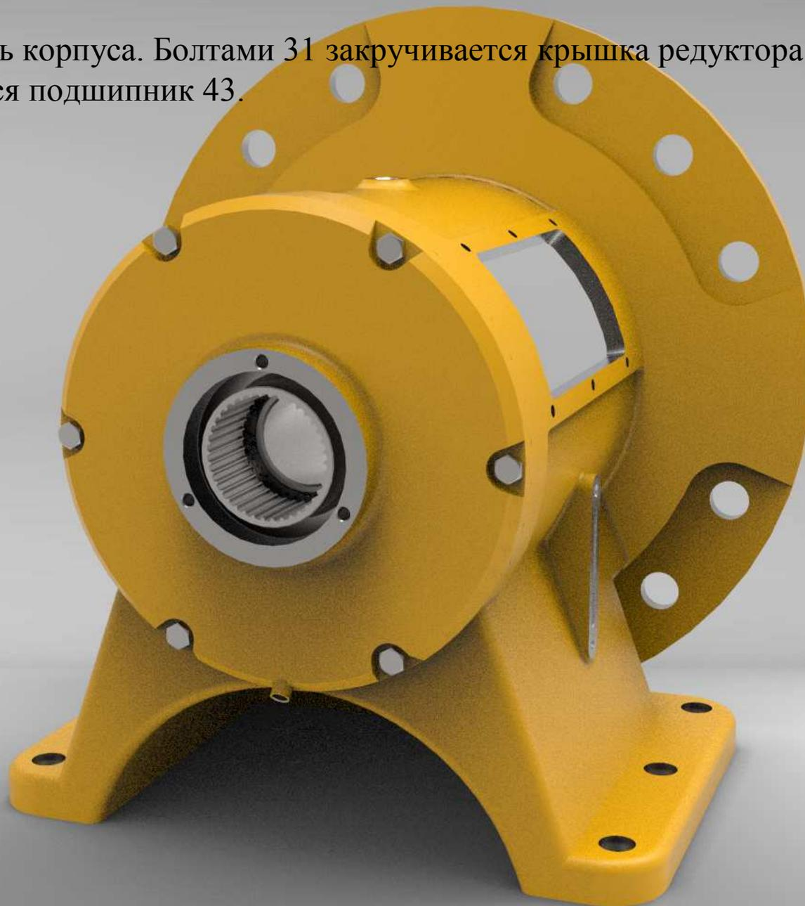
Вал 5 устанавливается в шлицы стакана. Устанавливается манжета 39 и, с помощью винтов 34 - крышка вала 12
