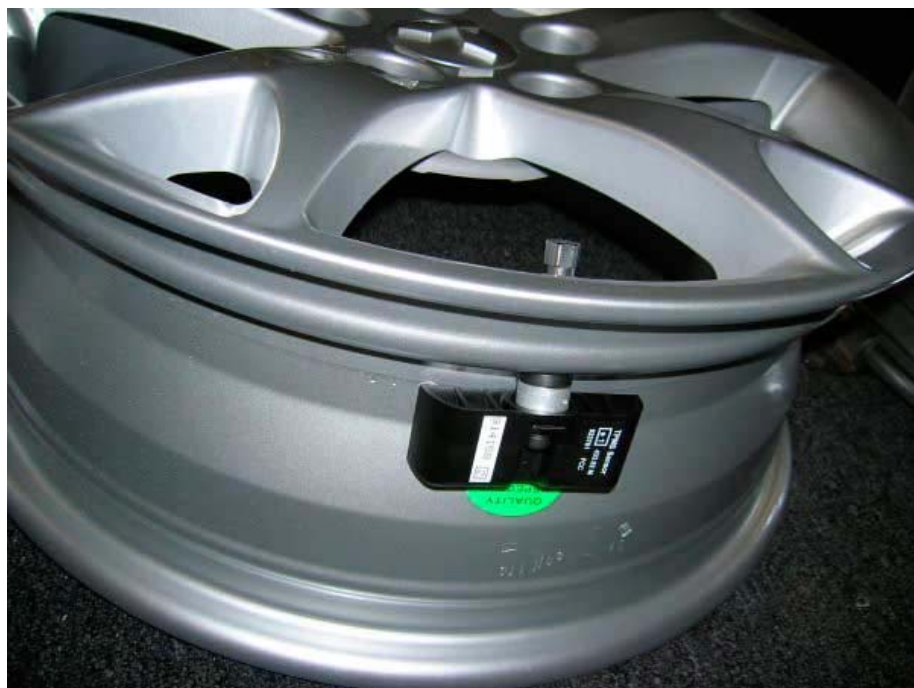
Рис. 4. Размещение датчика давления на ободу колеса
