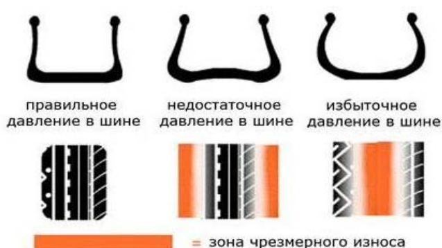
Рис. 1. Характер износа протектора шины в зависимости от давления в ней
