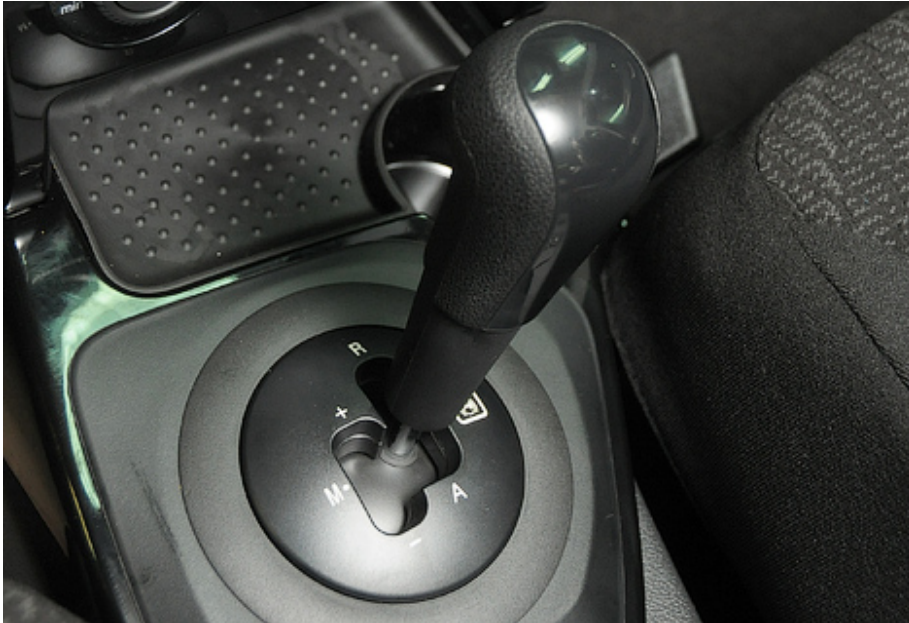
Рис 2. Важіль управління роботизованою коробкою передач автомобіля Lada Priora
