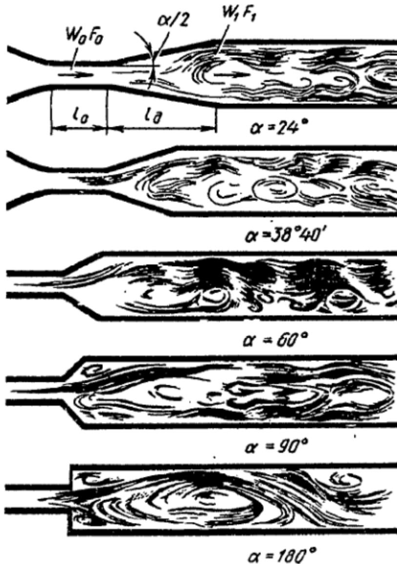
Для перехода от меньшего сечения трубы (канала) к большему (преобразования кинетической энергии потока в потенциальную или динамического давления в статическое) с минимальными потерями полного давления устанавливают плавно расширяющийся участок-*диффузор*
