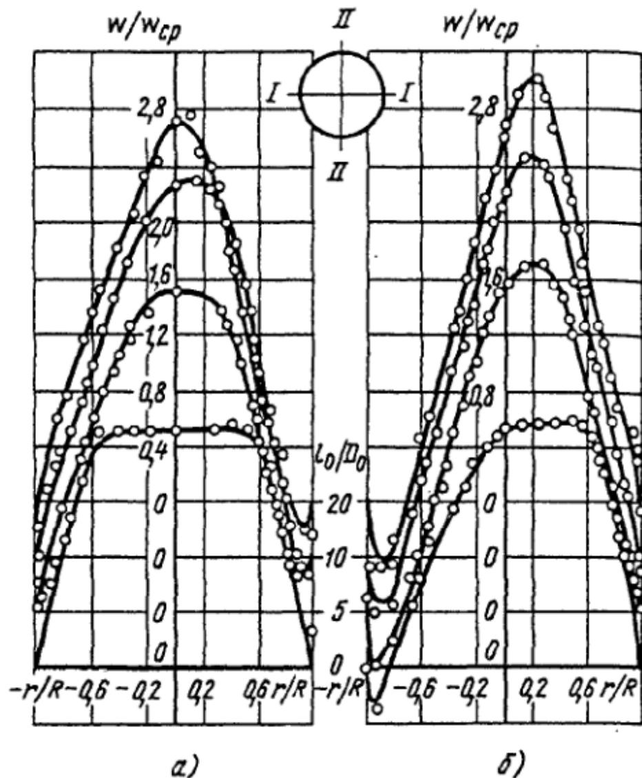
Поля скоростей в коническом диффузоре при  $\alpha = 10^\circ$  по сечению  $n_x = 4$  при  $Re = (4..5) \cdot 10^5$  и различных  $l_0 / D_0$ : а – диаметр I-I; б – диаметр II-II.
