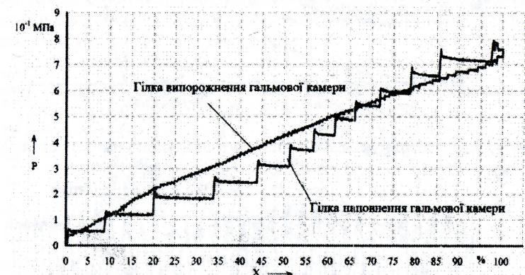
Рисунок 12 – Статична характеристика ЕПГП при регулюванні з попередженням залежно від швидкості наростиання сигналу 33
