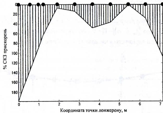
Рис. 4. Епюра відносних СКЗ прискорень на пружних лонжеронах при русі автомобіля по „бельгійській бруківці” зі швидкістю 11 м/с.
