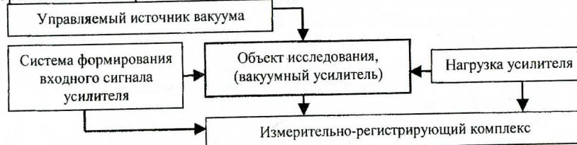
Рис. 8. Структура экспериментальной установки
