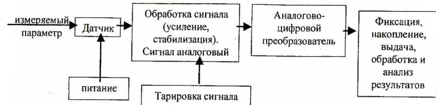
Рис. 9. Структура измерительно-регистрирующего комплекса
