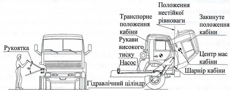
Рисунок 1 – Схема розташування гідравлічного механізму перекидання кабіни
