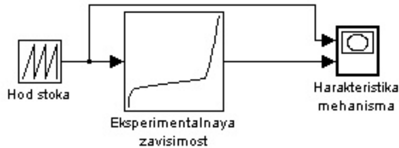
Рисунок 3.14 – Реалізація силової характеристики механізму зчеплення засобами бібліотеки Simulink
