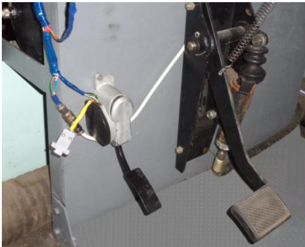
Рисунок 4.3 – Установка педального модуля КДБА.453621.001 на стенді
