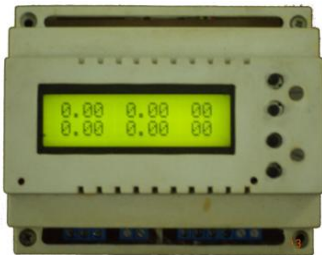
Рисунок 4.11 – Загальний вигляд цифрового таймера
