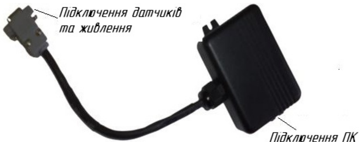
Рис. В. 1. Загальний вигляд електронного блоку керування
