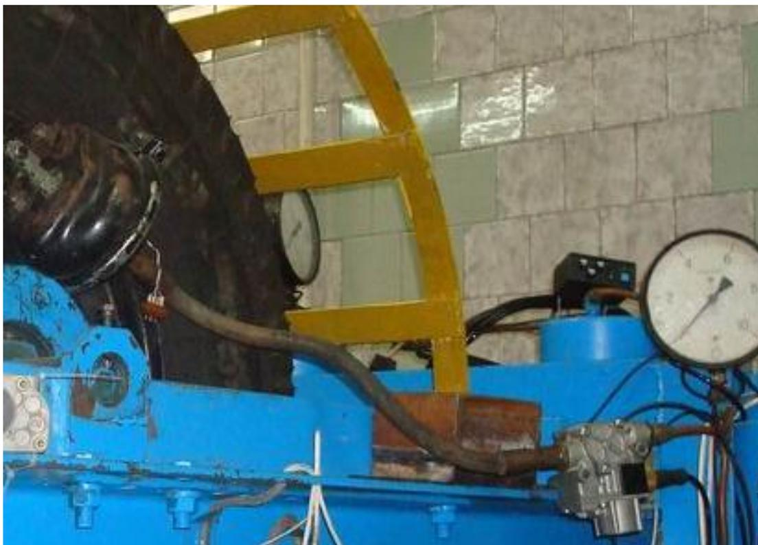
Рис. 4.26. Установка модулятора АБС-аналога на стенде
