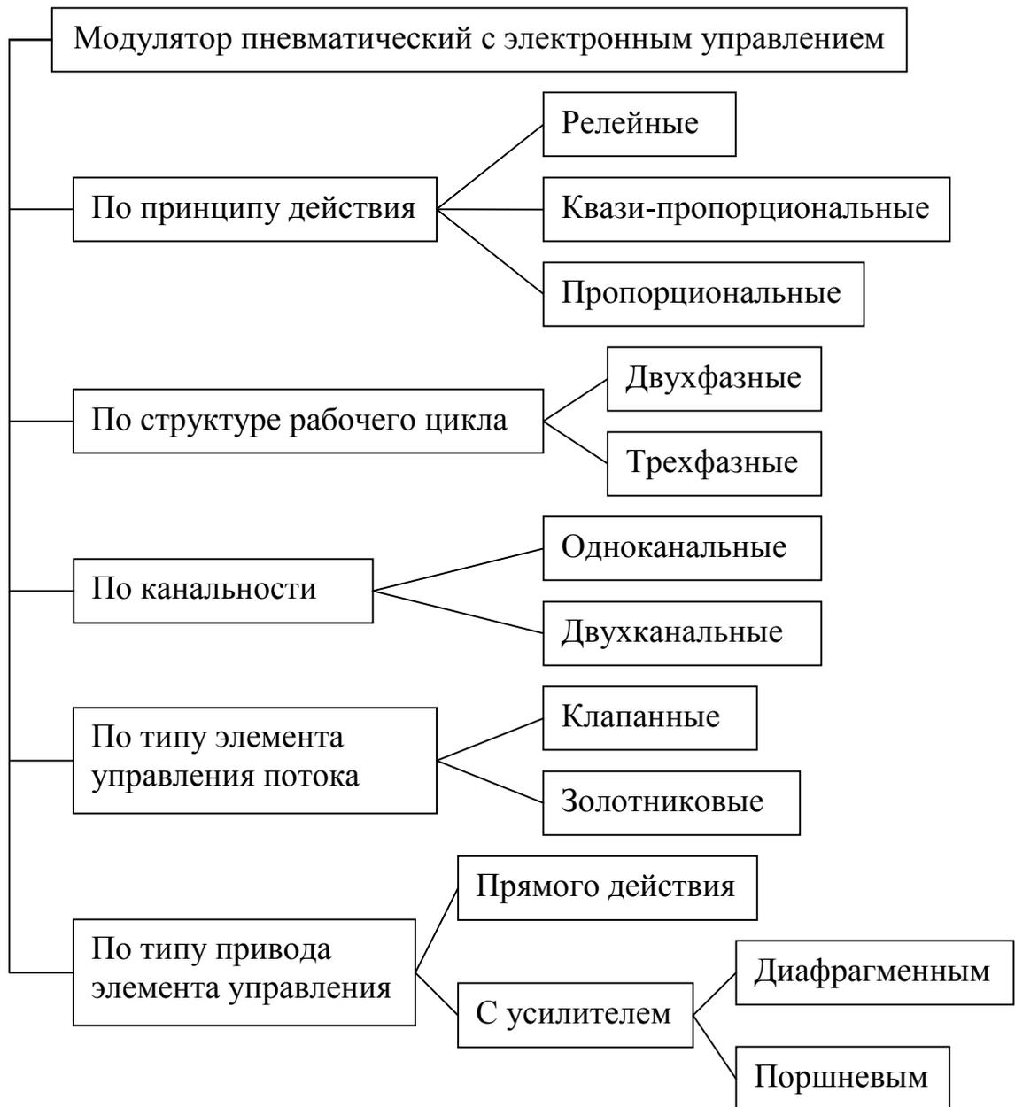
Рис. 1.21. Обобщённая схема классификации электропневматических модуляторов АБС
