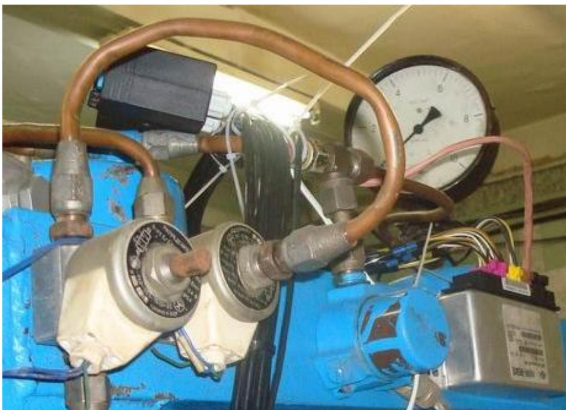
Рис. 4.27. Установка ЭБУ и системы питания АБС-аналога на стенде
