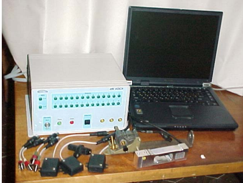
Рис. 1.14. Общий вид измерительного комплекса ИК ИЭСА и датчиков ходовой лаборатории кафедры «автомобилей».
