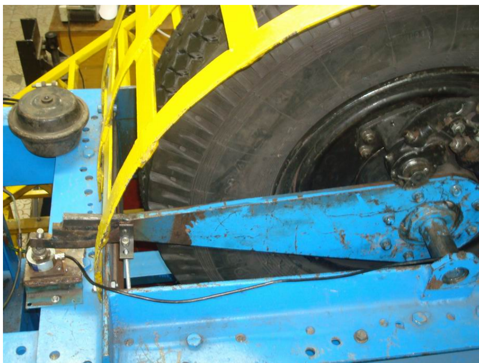
Рис. 4.8. Установка датчика усилия LPX-10000 на стенде.
