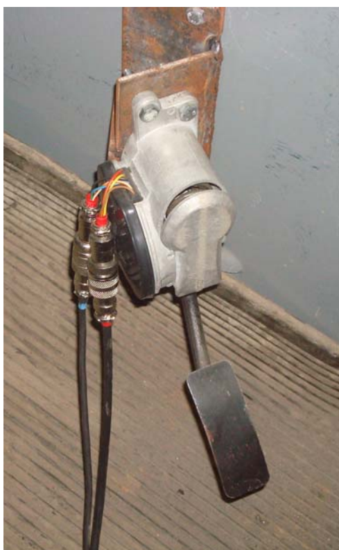
Рис. 4.6. Установка модуля педального КДБА.453621.001ТУ.
