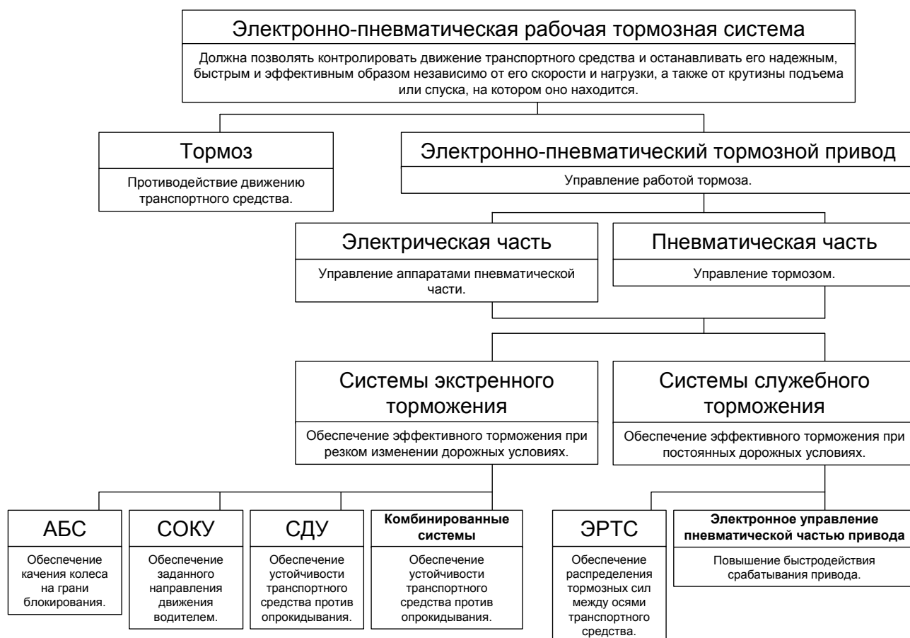
Рис. 1.1. Функциональная схема электронно-пневматической рабочей тормозной системы:
