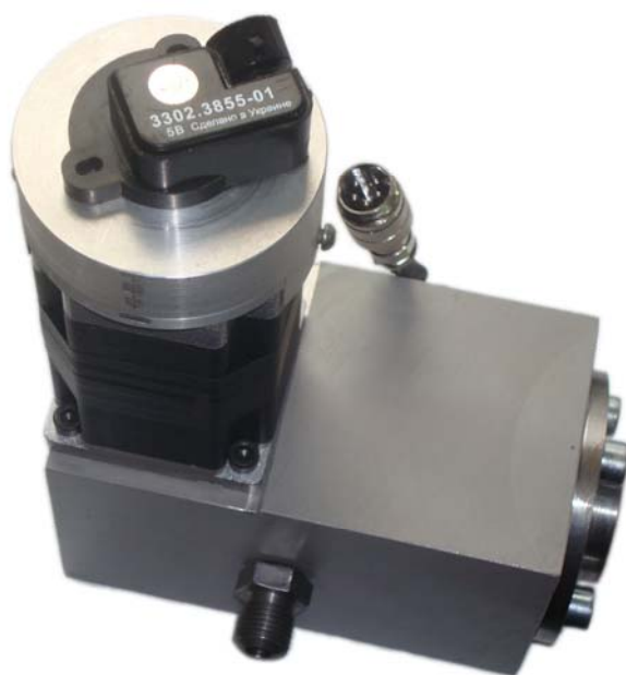
Рис. 3.5. Общий вид макетного образца пропорционального модулятора.
