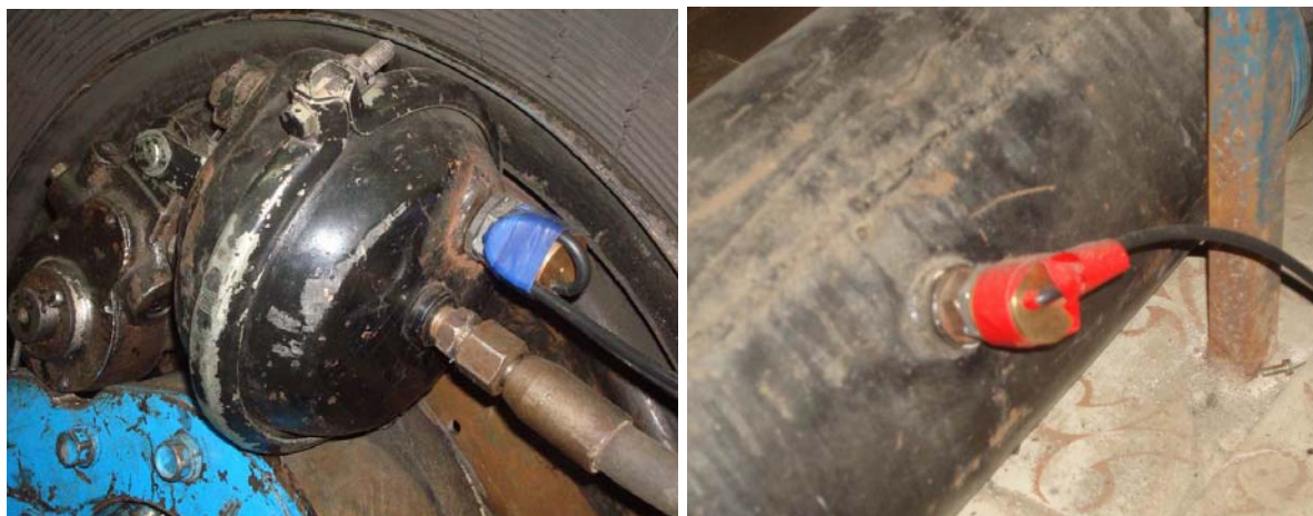
Рис. 4.5. Установка датчиков MPX 5999D на стенде:
