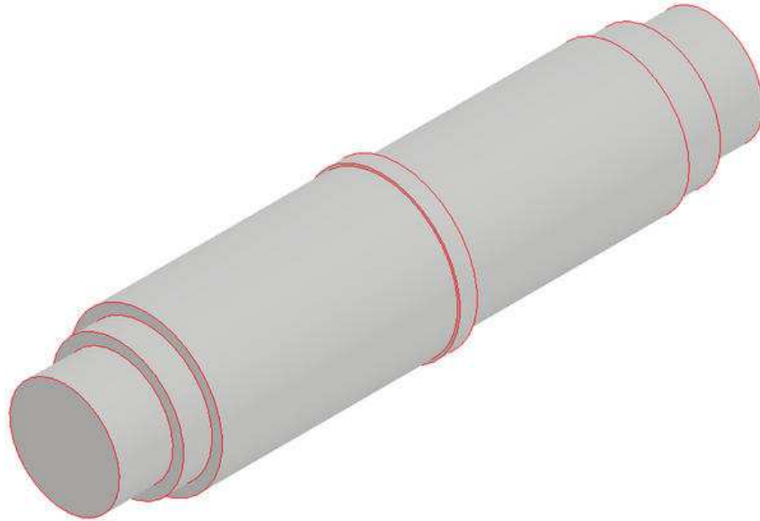
Рисунок 6 - Модель проміжного валу для ескізної компоновки
