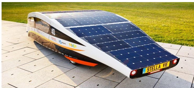
Рисунок 1 - Експериментальний сонцемобіль Stella Vie
