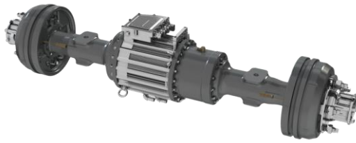
Рисунок 7 Привідний електричний міст американської фірми "Dana Inc."
