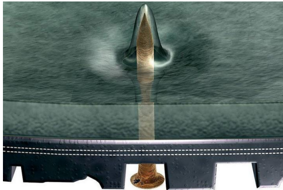
Рисунок 3 – Технологія самозаклейки шини
