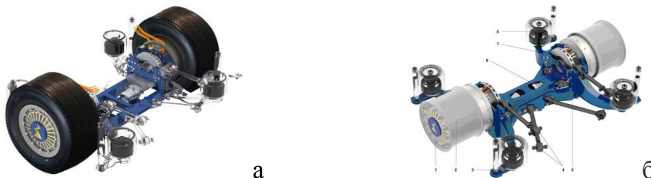
Рисунок 3 Портальний міст моделі "ZAwheel" із вбудованими у ступиці коліс ТЕД 1-го (а) та 2-го (б) поколінь (з електричними мотор-колесами)
