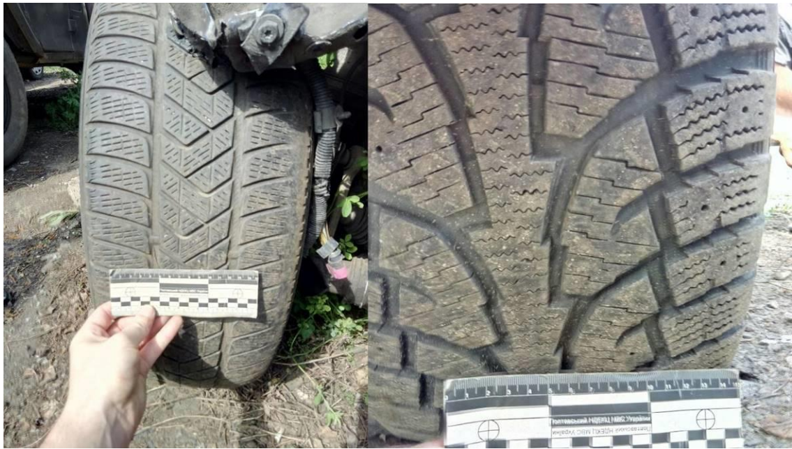
Рисунок 5 – Загальний вигляд шин передніх коліс з різним малюнком протектора автомобіля Volkswagen Touareg
