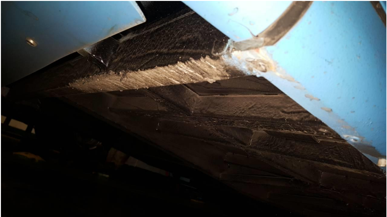
Рисунок 2 – Пошкодження поперечини в задній частині кузова
