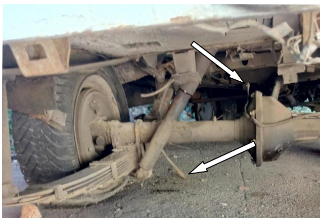
Рисунок 1, 2 – Загальний вигляд пошкодження гальмівного трубопроводу автомобіля РАФ
