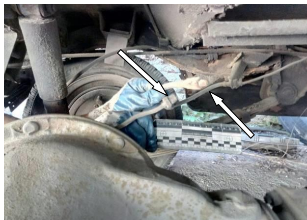
Рисунок 1, 2 – Загальний вигляд пошкодження гальмівного трубопроводу автомобіля РАФ
