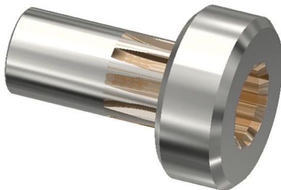
Рисунок 4 – Складальна одиниця «шліцьове з'єднання»
