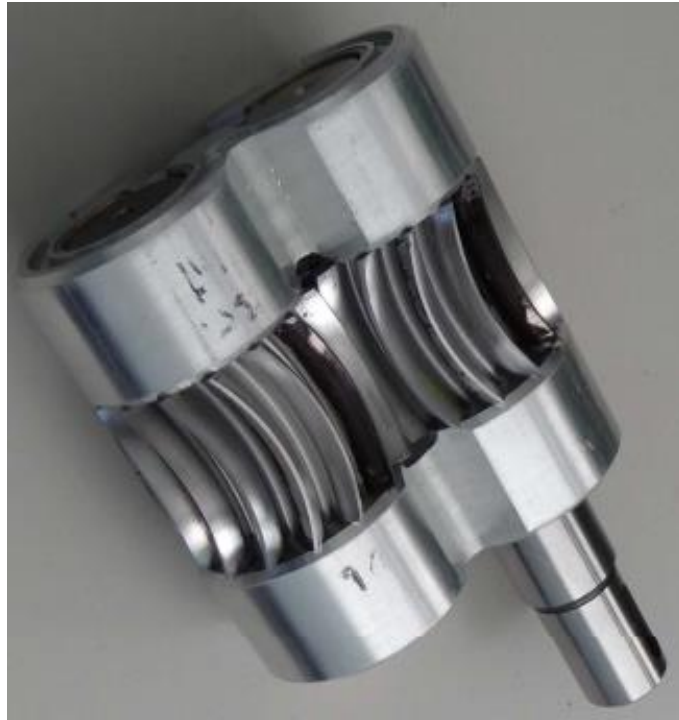
Рисунок 1 – Аркове зачеплення шестерінчастого насоса в зборі
