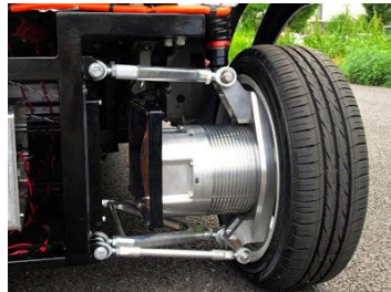
Рисунок 5 Мотор-колесо з ТЕД прямого приводу i незалежною пiдвiскою
