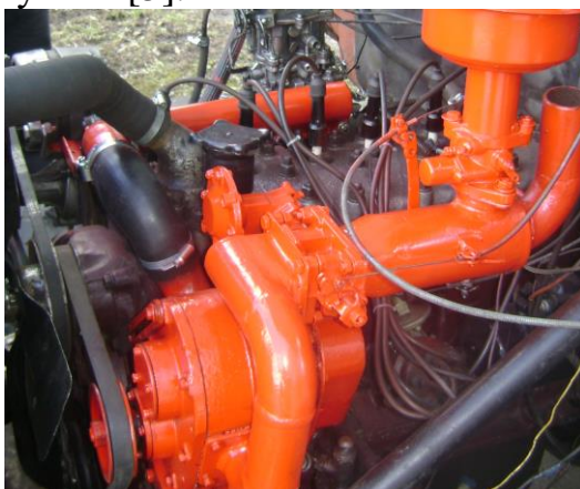
Рисунок 1 – Загальний вигляд нагнітача (з механічним приводом) газоповітряної суміші в циліндри двигуна
