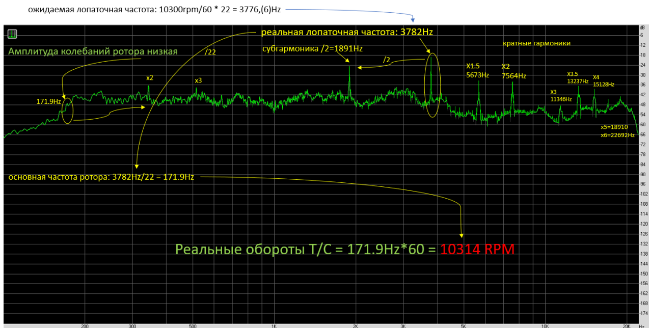
Рисунок 3 – Спектр віброакустичного сигналу лопаток компресорного колеса ТСА 66-20072 на режимі 5S60MC 85 rpm, 4500 kW (~ 50 %)
