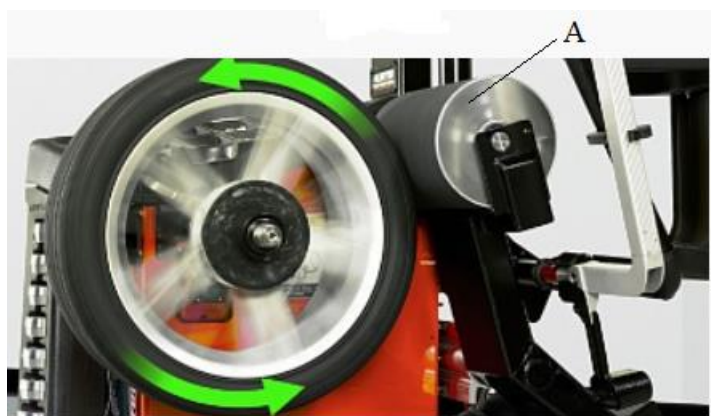
Рисунок 2 - Тестування колеса навантаженням: - А - навантажувальний ролер
