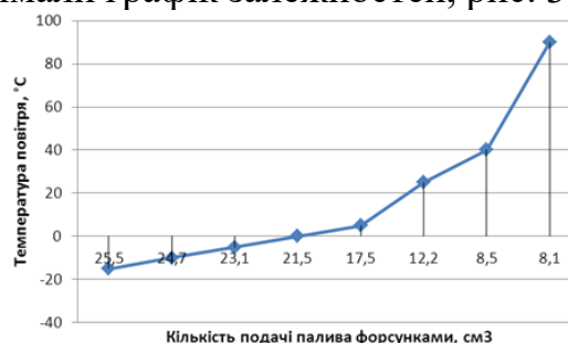
Рис. 3 – Графік залежності витрати палива на початку пуску і прогрівання двигуна, залежно від температури навколишнього середовища
