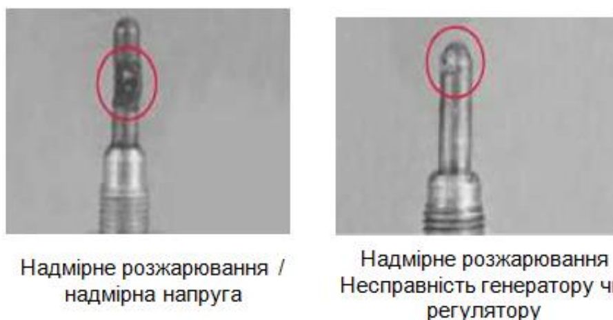
Рисунок 4 - Дефекти внаслідок аварійного живлення свічок
