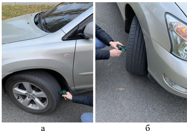
Рисунок 1 – Вимірювання значень температури шини в протекторній зоні (а) та боковій частині (б)
