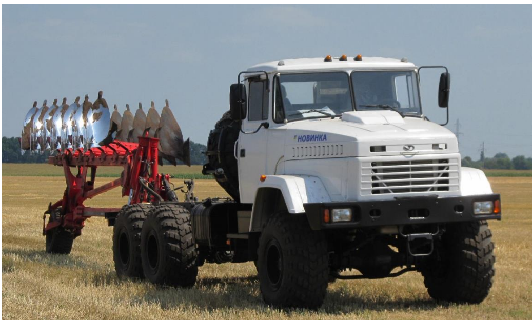
Рисунок 1 – Орний агрегат на базі мобільного енергетичного засобу МЕЗ-330 «Автотрактор» та плуга Nector 1000
