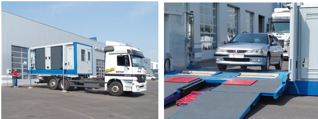
Рисунок 5 – Універсальна мобільна станція технічного контролю всіх типів автотранспорту MTL-15 фірми МАНА
