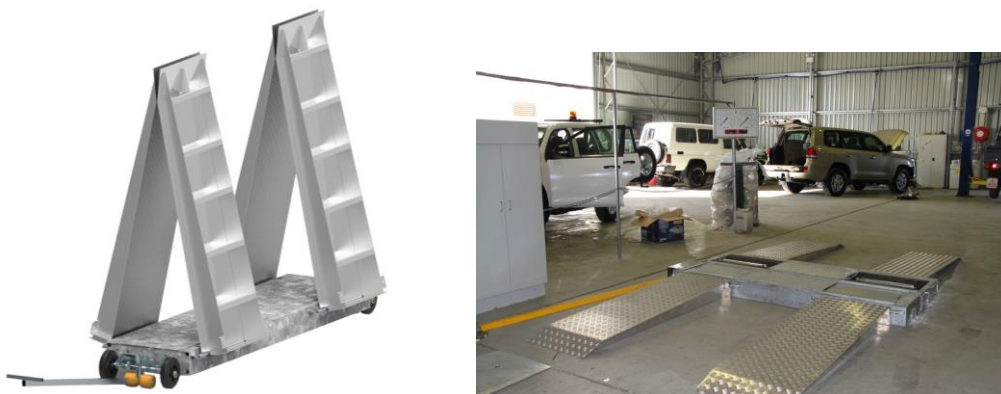
Рисунок 7 – Мобільний гальмівний роликовий стенд VM3010 (Данія)
