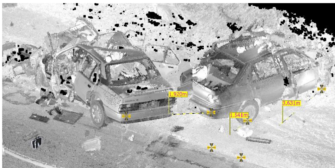
Рисунок 1 – Визначення розмірів та відстаней між об'єктами на місці ДТП за допомогою лазерного вимірювання або сканування
