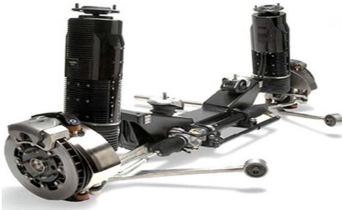
Рисунок 5 – Загальний вигляд електромагнітної підвіски
