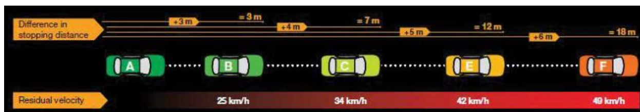
Рисунок 3 – Схема оцінювання зчеплення на мокрому покритті
