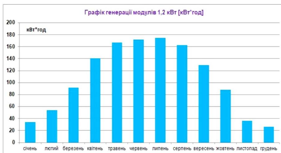
Рисунок 1. Генерація електроенергії автономною сонячною електростанцією потужністю 1,2 кВт
