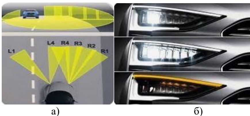
а) – Відображення роботи секцій світлодіодного модуля блок фари при зустрічному роз'їзді. Б) – загальний вигляд матричної блок фари під час її роботи у різних режимах. Рисунок 4 Загальний вид роботи секцій сучасної світлодіодної оптики
