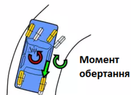
Рисунок 2 – Принцип роботи ESP
