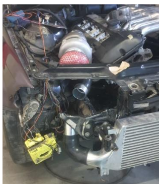
Рисунок 3 - Вигляд передньої частини автомобіля, після встановлення випускного колектору та турбонагнітача
