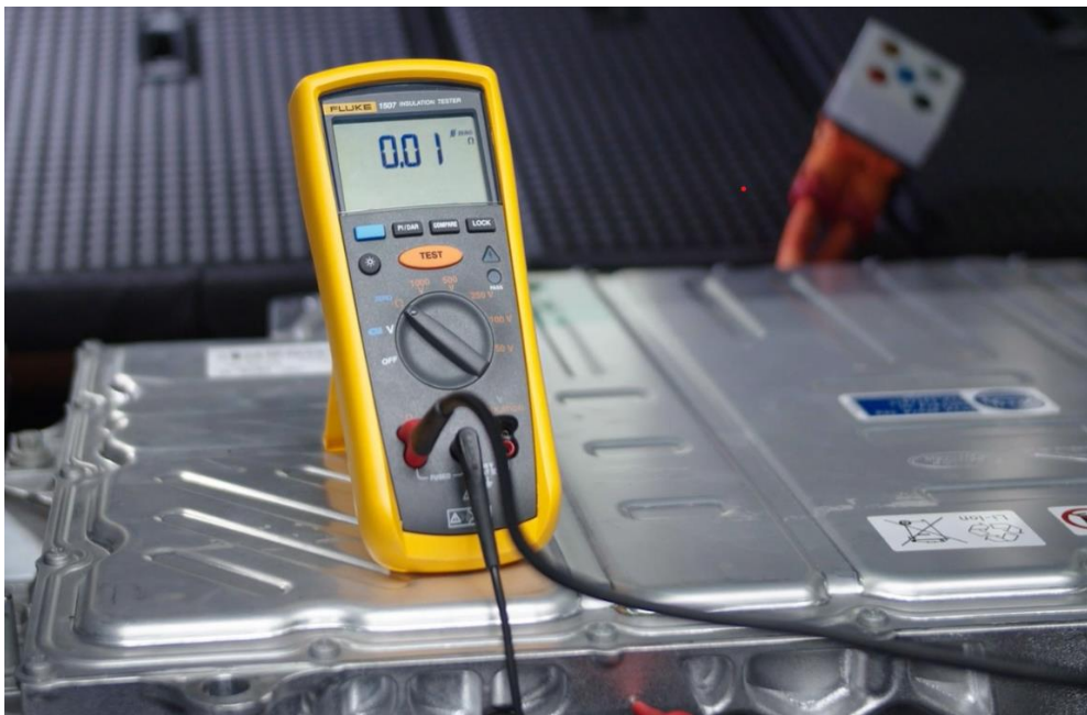
Рис. 3. Перевірка системи вирівнювання потенціалів за допомогою Fluke 1507.
