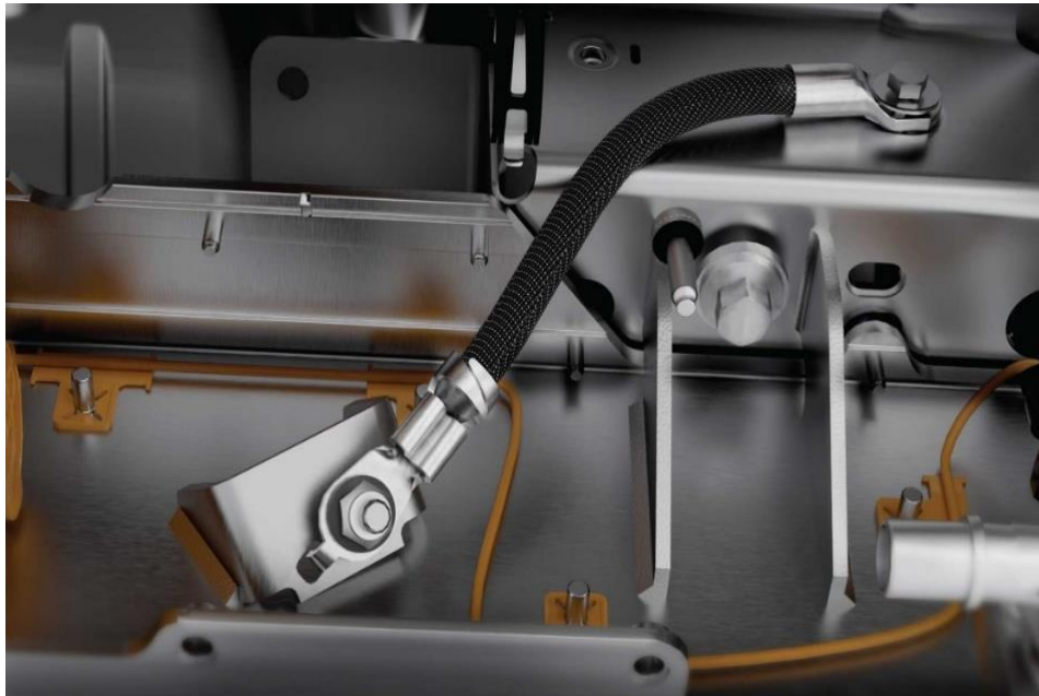
Рис. 2. Шина системи вирівнювання потенціалів.
