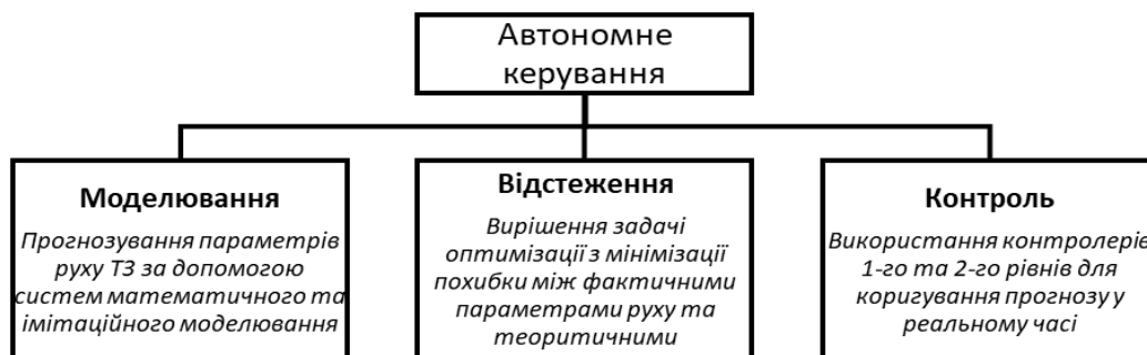
Рисунок 3 – Етапи розробки систем автономного керування ТЗ
