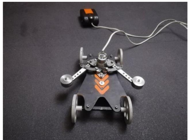
Рисунок 4.1 - Загальний вигляд масштабної моделі колісного малогабаритного транспортного засобу з інерційним рушієм під час випробувань
