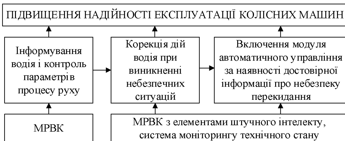
Рисунок 4.2 - Структурна схема забезпечення надійності експлуатації колісної машини
