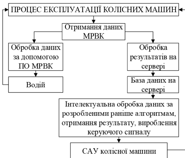
Рисунок 4.6 - Схема функціонування реєстраційно - іміврювального комплексу з елементами штучного інтелекту
