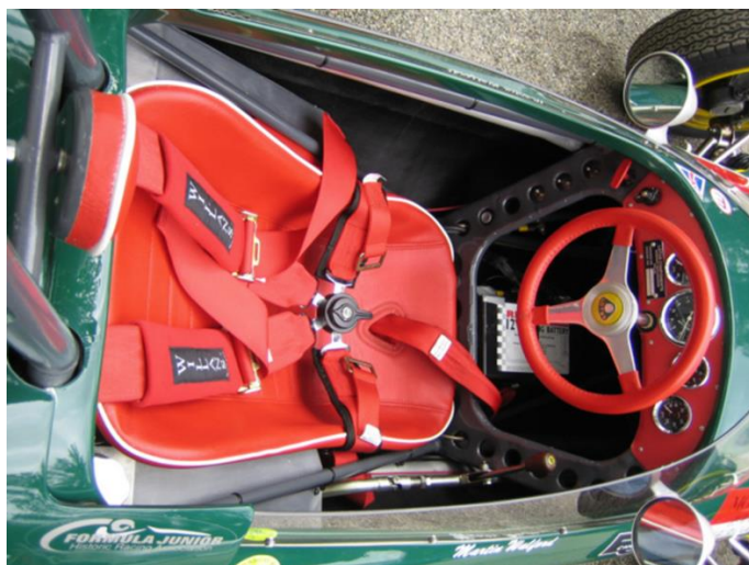
Рисунок 2 – Багатоточковий тип ременів безпеки
