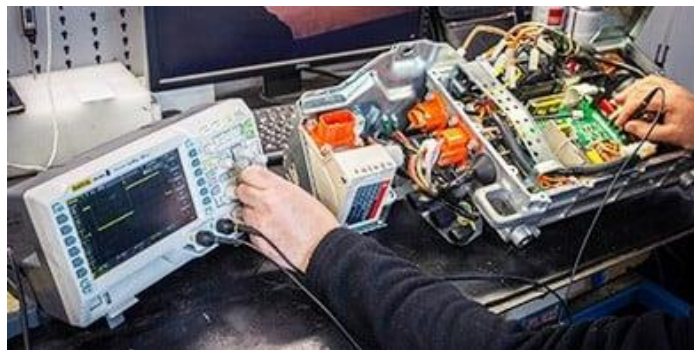
Рисунок 1 – Діагностика та ремонт силових систем EV
