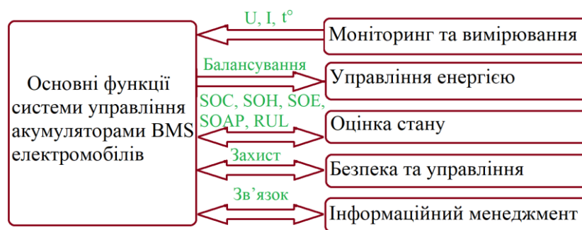
Рисунок 1 – Основні функції системи управління акумуляторами BMS електромобілів
