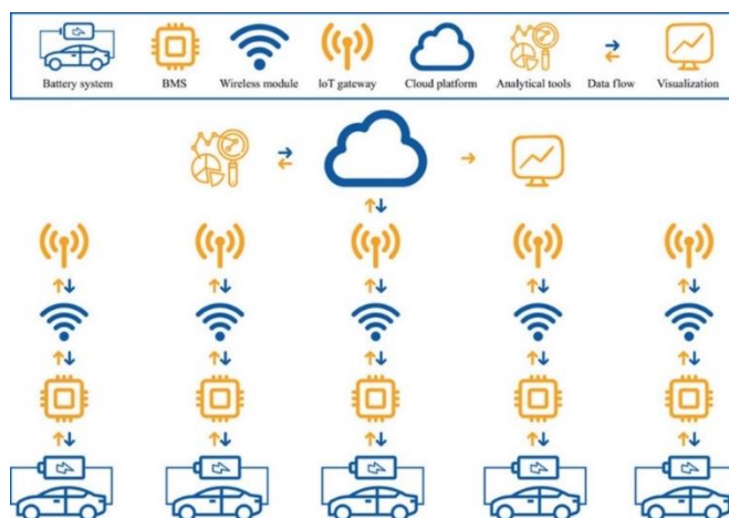
Рисунок 1 – Архітектура Інтернету акумуляторних батарей електромобілів [3]
