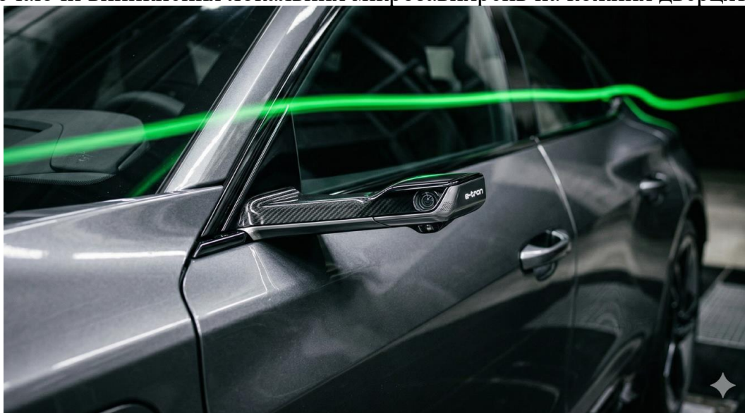
Рисунок 8 - Віртуальні дзеркала-камери (Virtual Mirrors)
