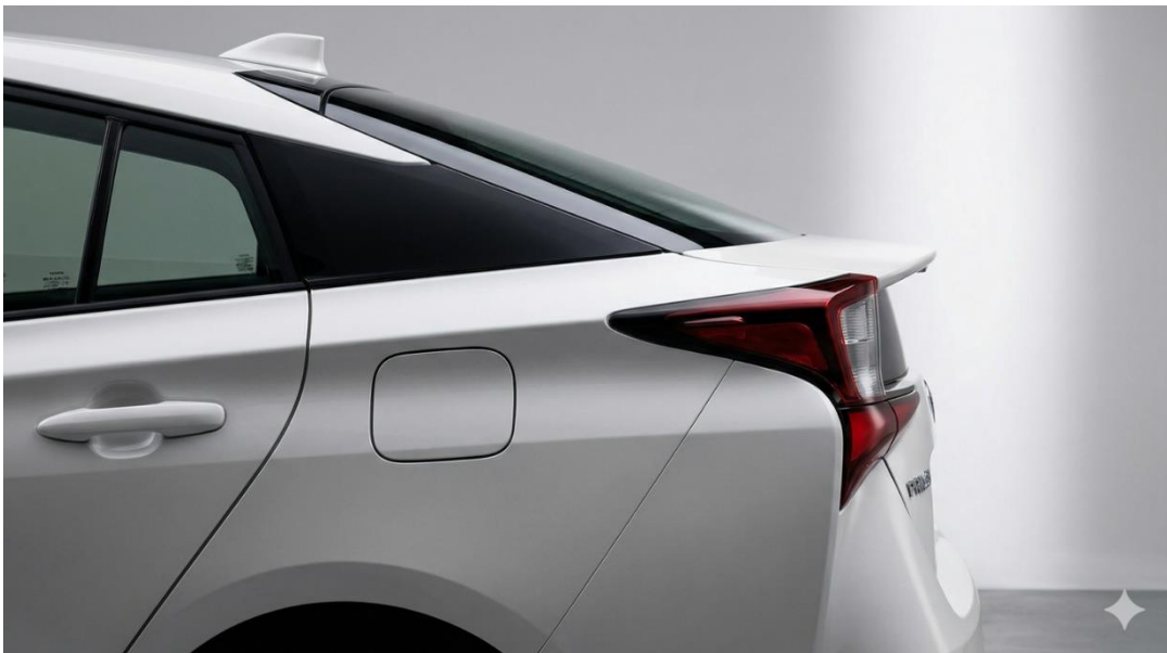
Рисунок 6 - Хвіст Камма (Kammback) на прикладі Toyota Prius
