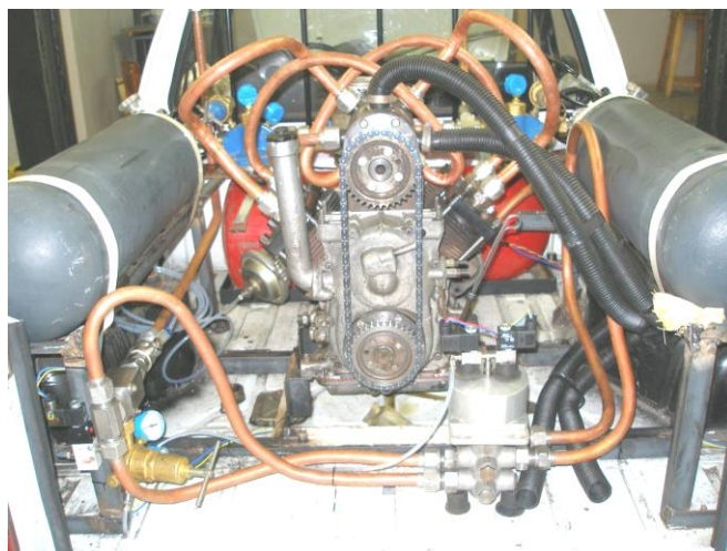
Рисунок 3 - Поршневий пневмодвигун, встановлений на гібридній силовій установці автомобіля, для проведення дорожніх випробувань
