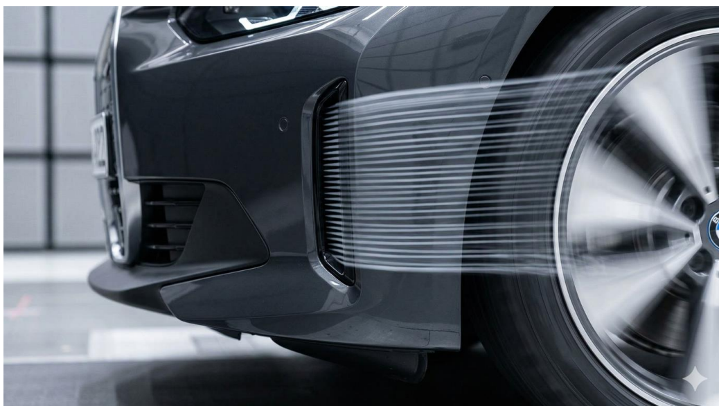
Рисунок 7 - Повітряні штори (Air Curtains) на передньому бампері
