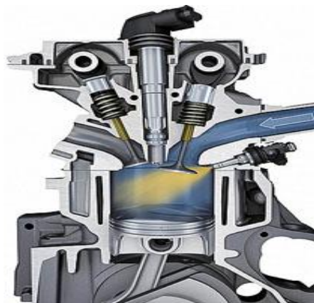
Рис.3. Система безпосереднього уприскування
