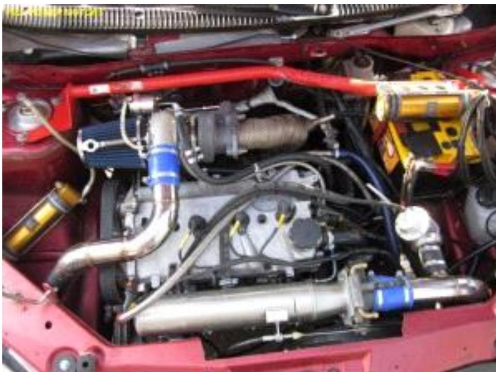
Рисунок 3. Турбированный Мотор Лады Калина
