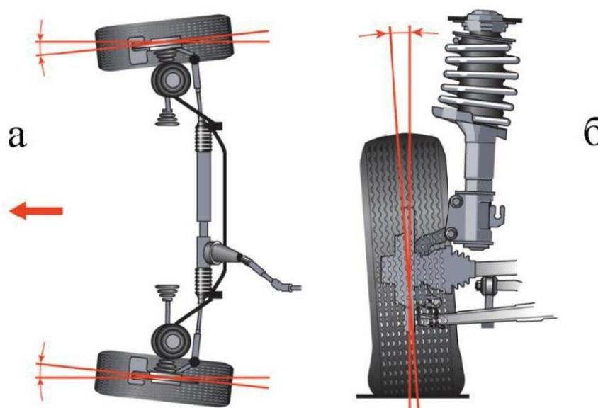
Рис.1 – (а) схождение и (б) развал колес
