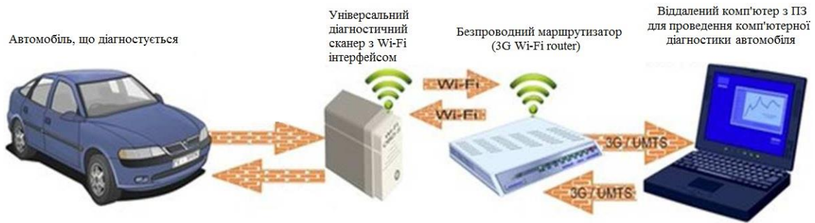
Рис. 3. Взаємодія між автомобілем і комп'ютером віддаленої діагностики
