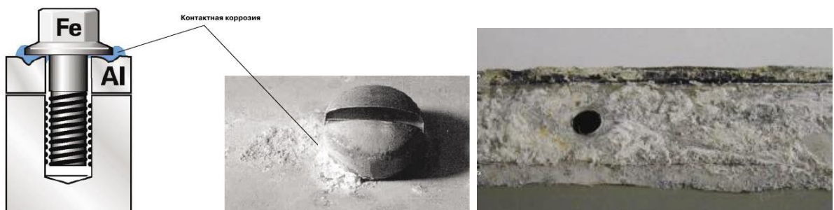
Рисунок 3 – Контактна корозія металів
