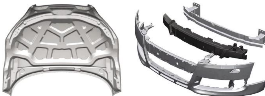
Рисунок 5 – Комірчаста структура внутрішньої панелі алюмінієвого капоту та система гасіння енергії при ударі пішохода
