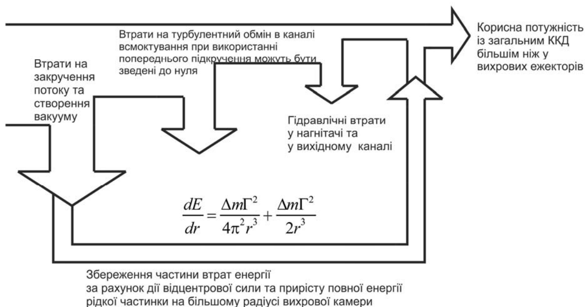
Рисунок 2.5 – Структура втрат енергії в вихорокамерному нагнітачі при перекачуванні однофазних середовищ
