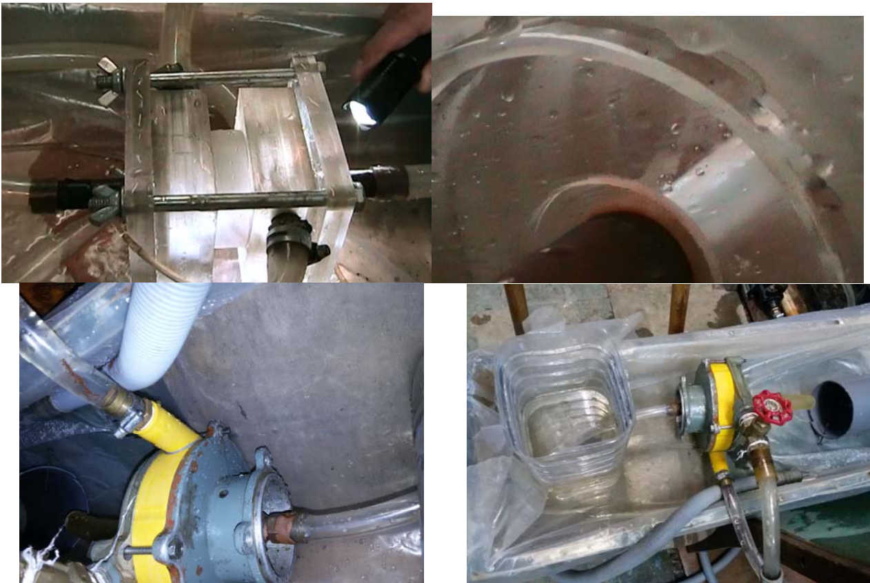
Рисунок 4.5 – Фотографії експериментального зразка при роботі на воді та утворення вихрового шнуру
