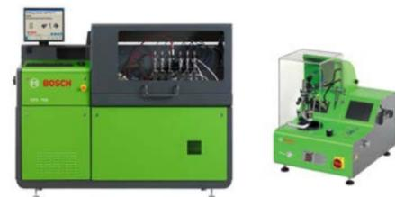
Оборудование для проверки компонентов топливной аппаратуры: стенды для проверки ТНВД, приборы проверки форсунок
