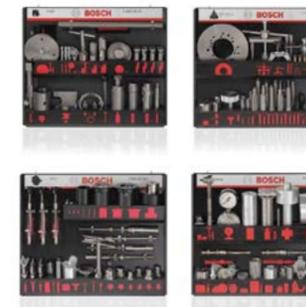
Наборы для ремонта, диагностики и регулировки ТНВД Bosch всех типов
