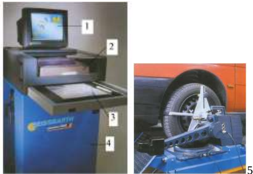
1 – монітор; 2 – клавіатура; 3 – графічний планшет; 4 – корпус; 5 – вимірювальна головка
