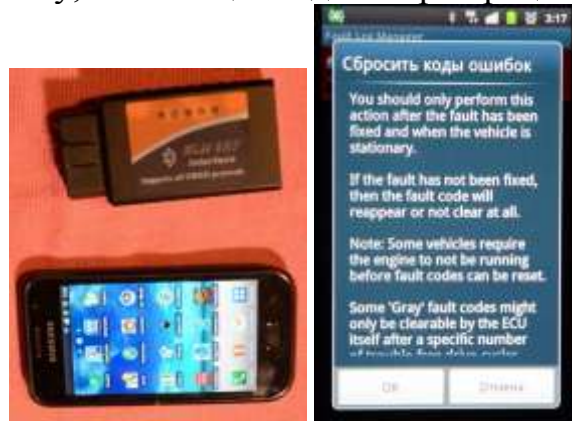
Рисунок 5 - Діагностика і скидання коду несправності за допомогою адаптера та смартфона
