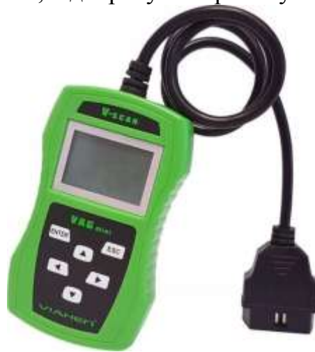
Рисунок 2 – Дилерське обладнання для діагностики автомобілів AUDI, Volkswagen
