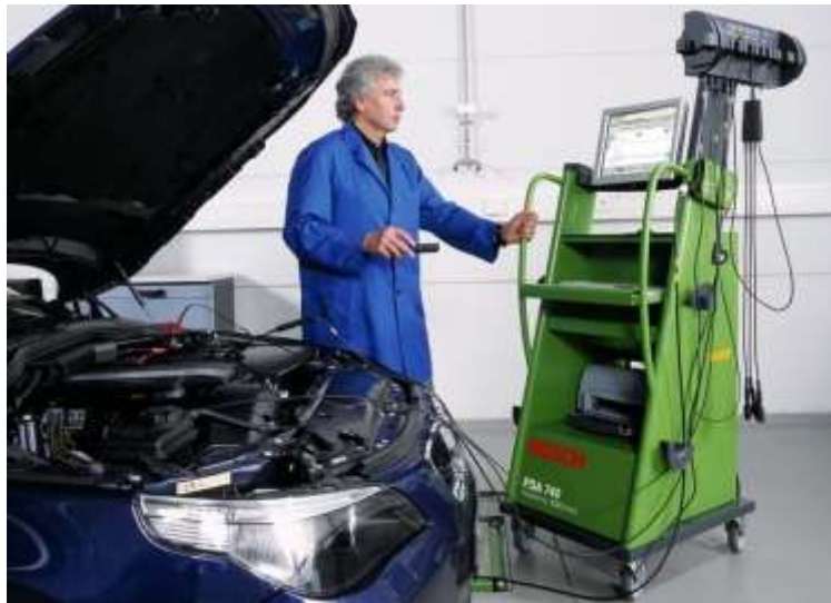
Рисунок 1 – Підключення цифрового сканеру до автомобіля
