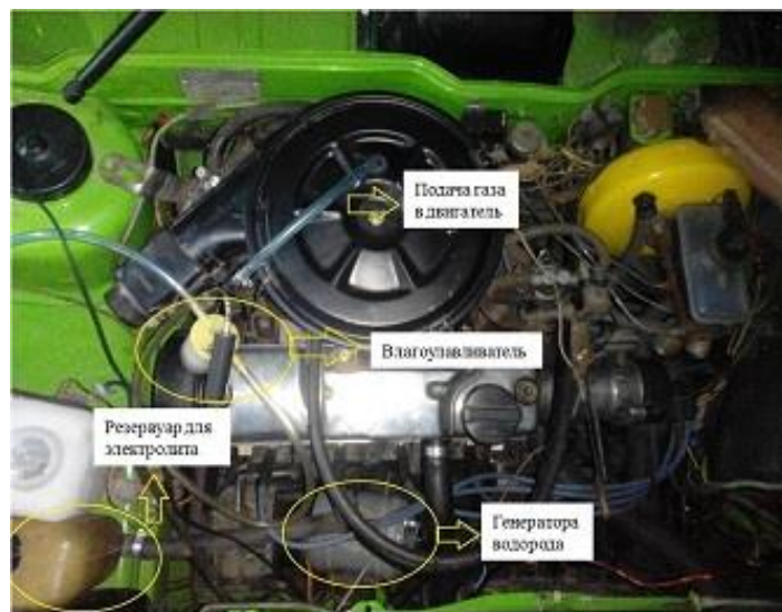
Рис. 3 - Генератор водню з «мокрими» пластинами, встановлений на експериментальному автомобілі ВАЗ-2109
