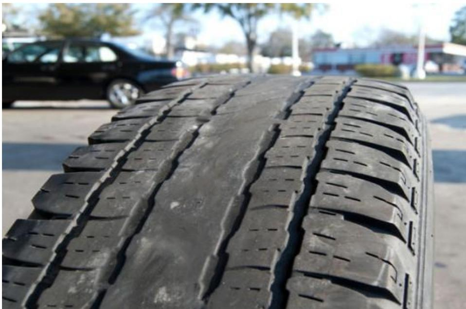
*Рис.1- Износ протектора резины по центру (посередине)*
