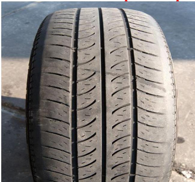
Рис.4 - Излишний износ протектора по краям
