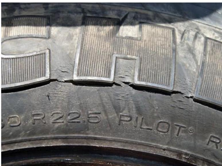
Рис.2 - Грыжа шин (выпучивание) и трещины на боковой стенке
