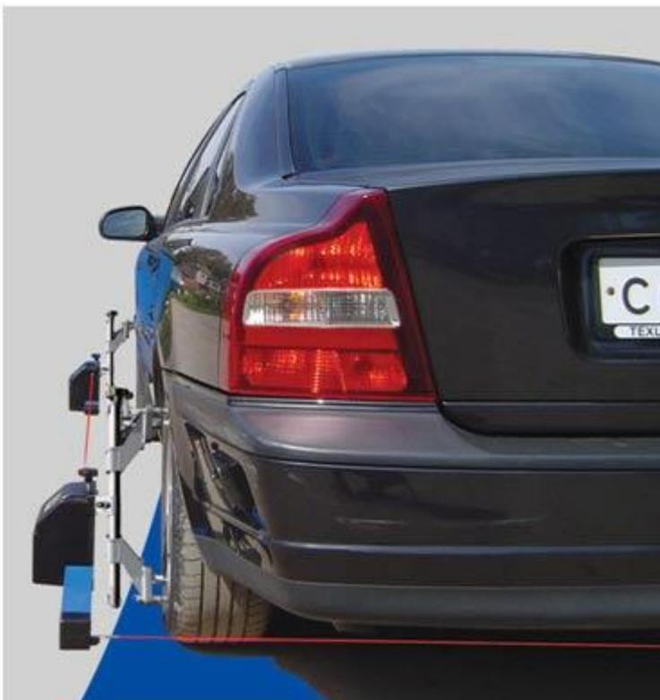
Измерительные блоки передают собранную с датчиков информацию на компьютер. Кордовые стенды доступны по цене и быстро окупаются, их просто использовать, они достаточно надежны, функциональны и точны. По этим причинам они часто используются в небольших автосервисах.
