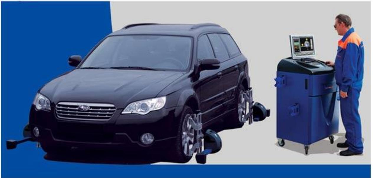
Измерительная система строится на базе CCD матриц высокого разрешения, что позволяет измерить с высокой точностью схождение, колесную базу и ширину колеи, а также схождение в повороте без использования электронных поворотных кругов.
