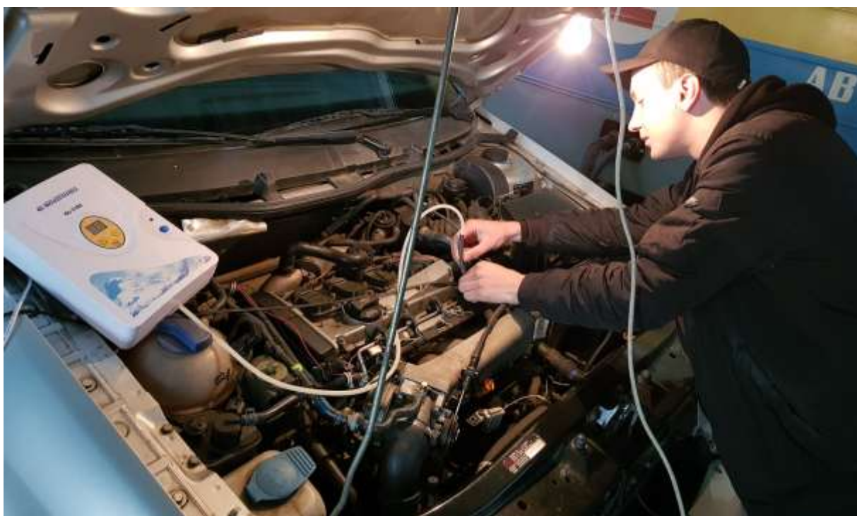
Рис. 1.4 – підключення озонатора до впускного колектору
