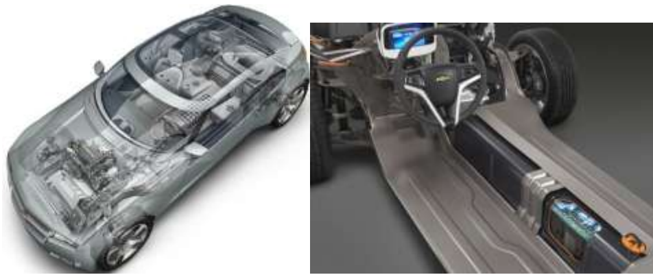
Рисунок 2 – Гібридна технологія E-REV автомобіля Chevrolet Volt
