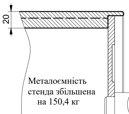
Рис.1 – Доробка конструкції нового стенду шляхом збільшення товщини стінки ролика
