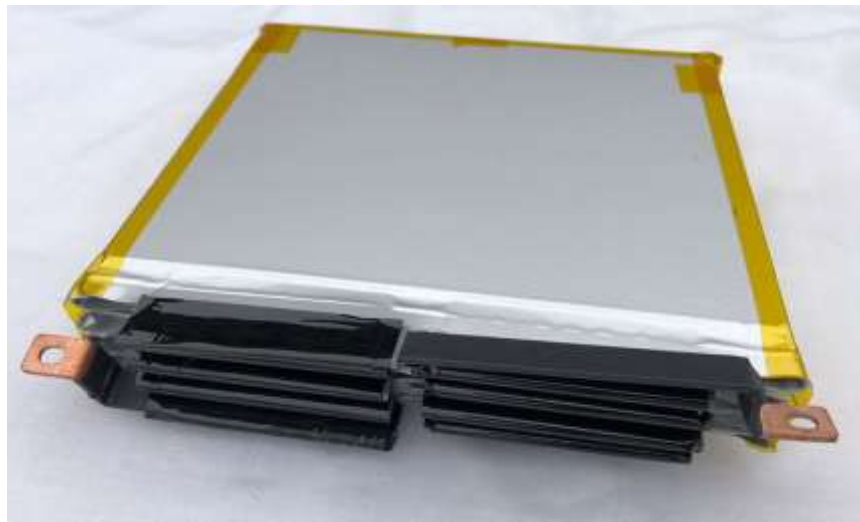
Рисунок 1 - Натрійіонні акумулятори Natron (Kyoto University)
