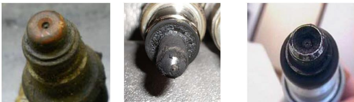
а) б) в) а - лакові відкладення; б - смолисті відкладення; в - нагар
