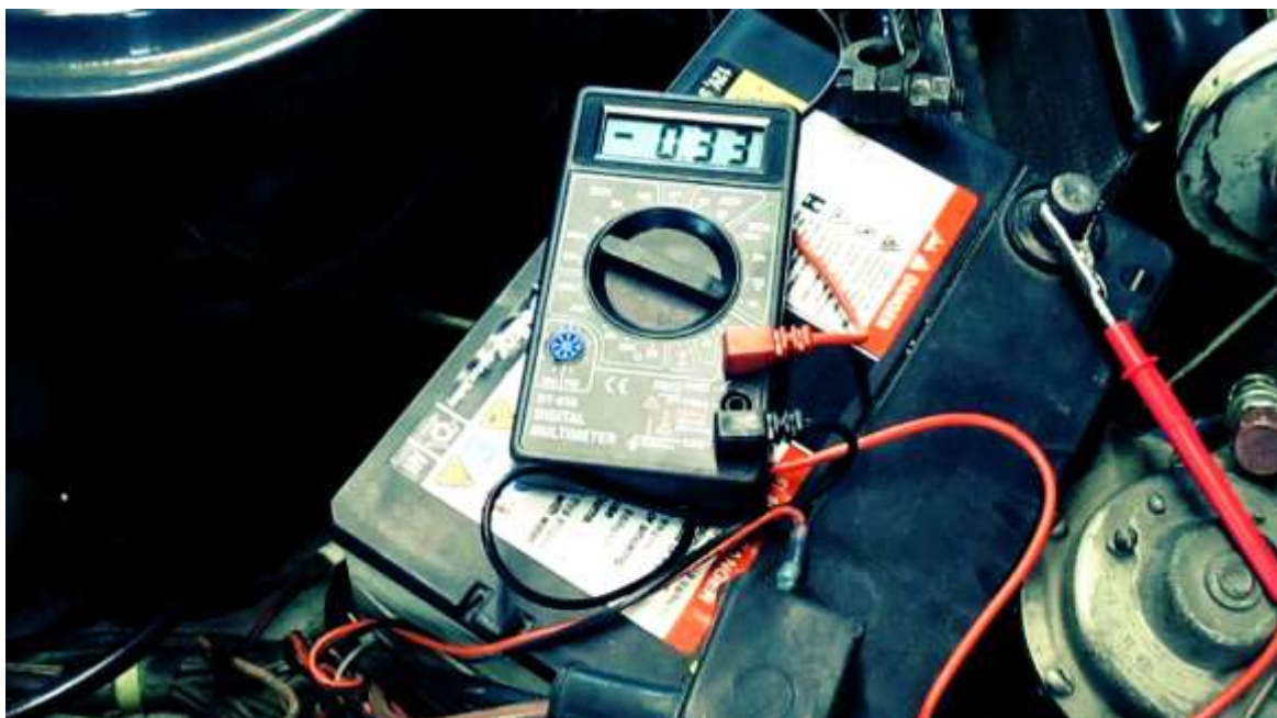
Рис.2 – Підключення мультиметра для перевірки генератора.
