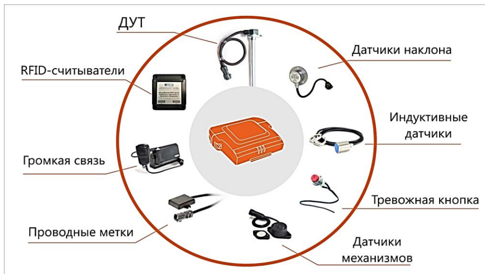
Рис. 2 – Датчики для зняття характеристик за допомогою трекера
