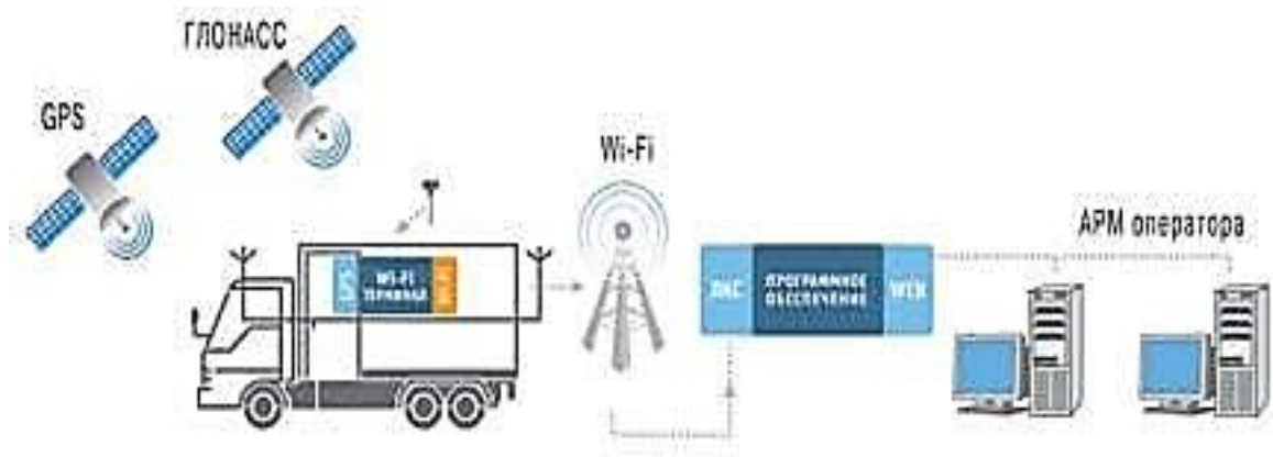
Рис. 4 – Схема роботи за відсутності покриття мережі
