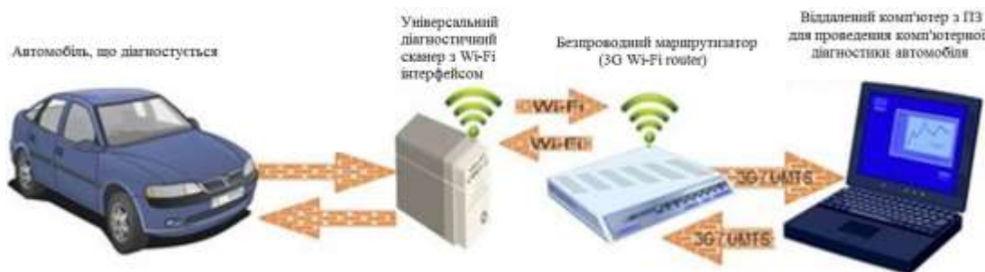
Рис. 3 – Взаємодія між автомобілем і комп'ютером віддаленої діагностики
